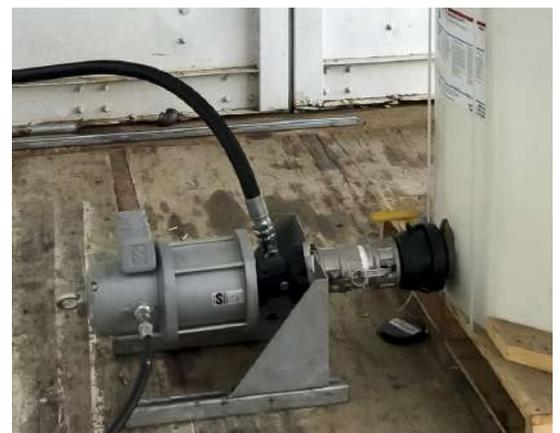
Horizontal montierter Pumpensatz für den massiven Fetttransport im Tank.
