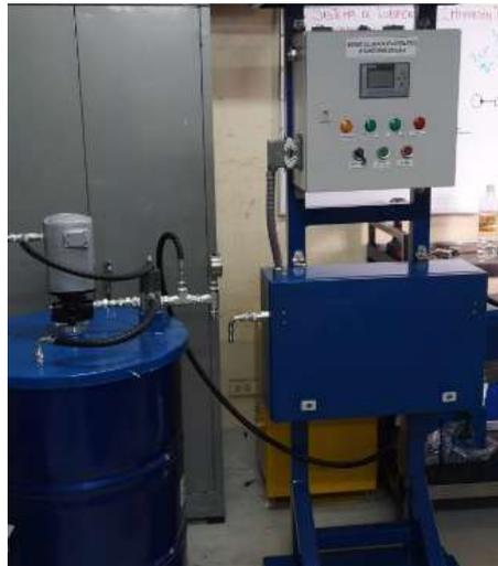
Automatische Schmierung mit Steuerung
