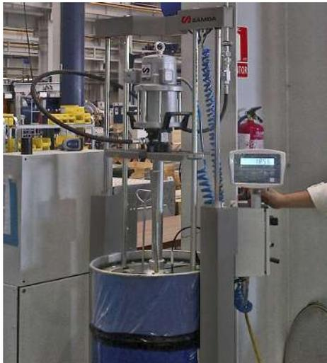
Automatische Schmierung mit Steuerung
