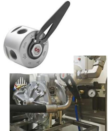
**Vier-Wege-Ventile** vereinfachen die Rohrleitungen und ermöglichen die Verwendung einer Pumpe, um Abwässer mit einem Handgriff in den Lagertank zu befördern oder aus ihm herauszuholen.
