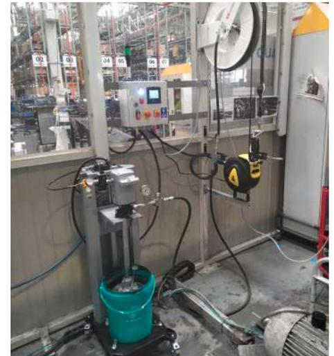
Automatische Schmierung mit Steuerung
